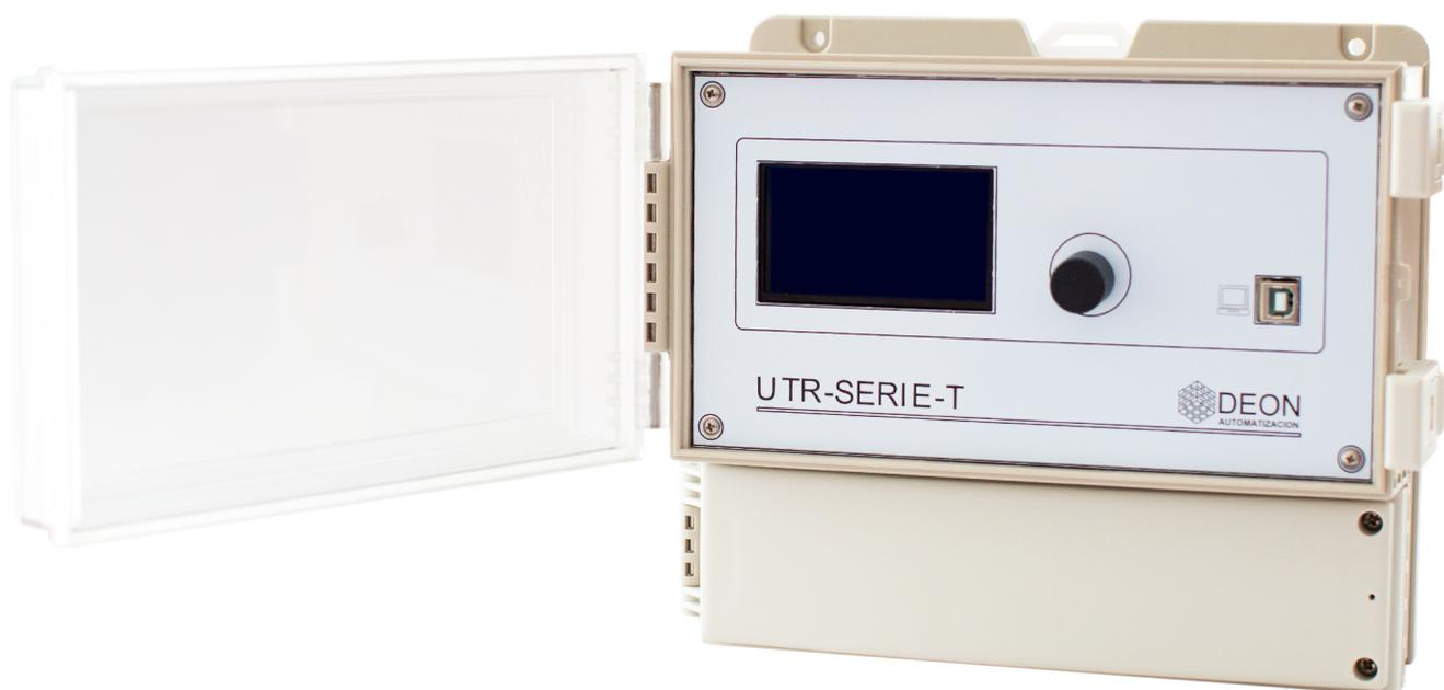
La **UTR-SERIE-T** cuenta con **4 canales analógicos** del tipo 0/4-20mA para adquisición de parámetros, principalmente de Nivel de tanques y/o cisternas, puede alimentarse con **energía eléctrica 115V o 220V**, o bien mediante panel solar y baterías. Los parámetros adquiridos podrán ser transmitidos mediante sistema de transferencia de datos GPRS al
